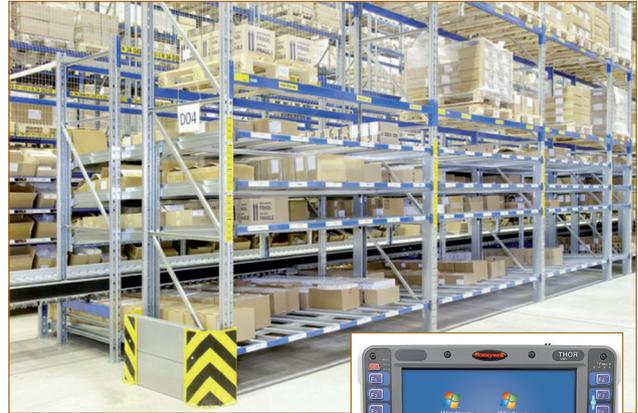
Грузы перемещаются в несколько этапов. Организованы транзитные ячейки для временного хранения грузов, поступающих с производства. Ричтраки перемещают грузы и размещают их в постоянные ячейки хранения. Правила маршрутизации позволяют задать необходимые маршруты для разных видов грузов и распределить их между единицами техники.
